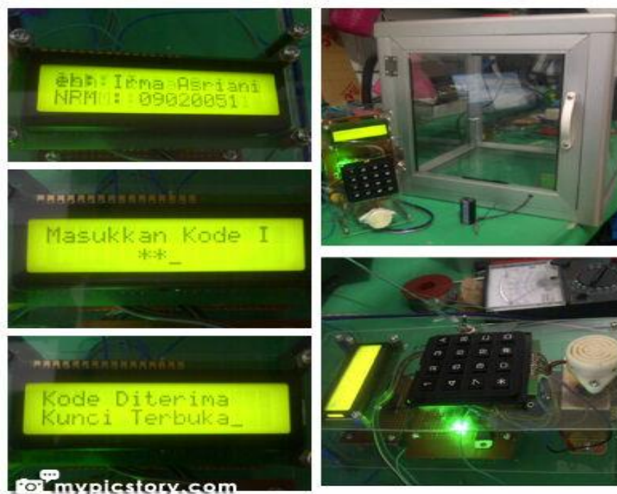
Gambar 3 Hasil uji coba kode kunci telah terbuka
