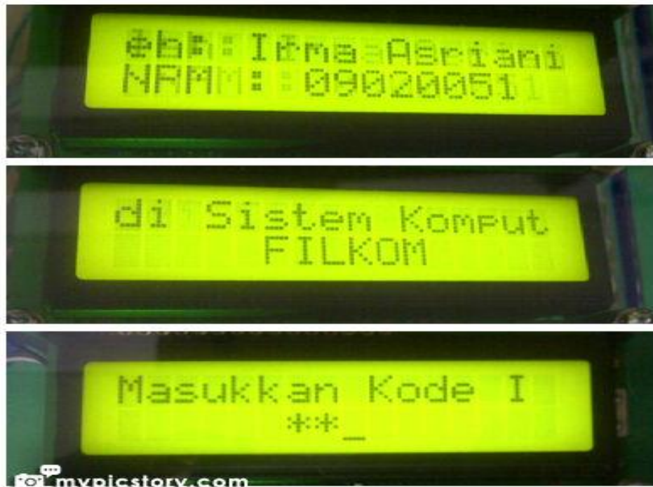
Gambar 2 Hasil uji coba masukkan kode keamanan
